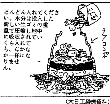
図2 簡易堆肥器の仕組み
