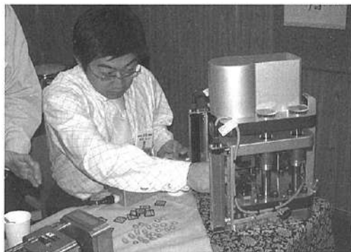
写真2：町家プレスで薄板を型抜き
